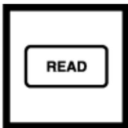
8. 当所有的数字都显示为合适的值后，按下 **READ** 键。仪器将从 60 到 0 计数（如果信号平均功能开启，则从 67 到 0 计数），然后测试浊度并存储该值。显示值将自动递增到下一个标准液。将样品池从样品池盒中取出。
