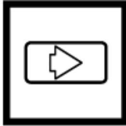
停止闪烁而显示屏左边的数字将闪烁。使用 ↑ 键滚动到正确的数字。再按下 → 键将图标移到下一个数字，并按同样的方法编辑。
