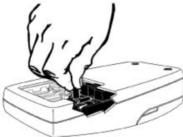
8. 用拇指使装置向前滑动直到停止不动。再一次按紧突起部分，以确认灯已在正确的位置。
