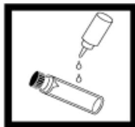
1. 用一个清洁的容器收集具有代表性的样品。将样品加入样品池至刻度线（约 15mL）。操作时小心握住样品池的上部。然后盖上样品池盖。（请参见第 10 页第 2.3 节以获得更多关于收集具有代表性样品的信息。
