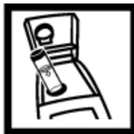
6. 重复 步骤3 到 步骤 5 以进行其它 Gelex 标准液的测试，请注意样品池的正确方向。
