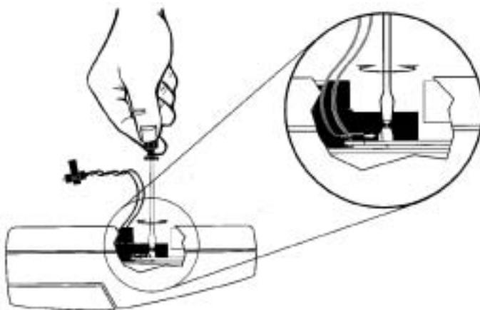
6. 抓住灯装置的突起部分，使灯对着仪器的上部（即键盘）。将装置的另一边的小钩滑入黑的塑胶槽中（对着仪器最近的边缘）。
