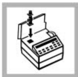
22. 将 COD 试剂瓶的插槽放入插槽固定器中。
