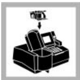
21. 当颜色已生成后，将 AccuVac® 安瓿瓶插槽插入仪器中。
