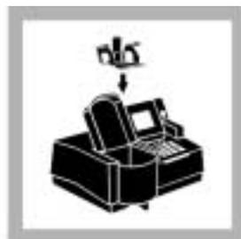
3. 将测试试管插槽滑入翼形螺钉下部的固定槽中，使其进入样品池组件中。然后用翼形螺钉紧固。
