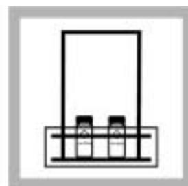
16. 将冷却水换上新鲜样品及空白样品池的支架放入冷水浴中。
