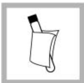
21. 从水中取出试剂瓶，然后用一块干净而干燥的纸巾擦干。将试剂瓶颠倒几次以混合。
