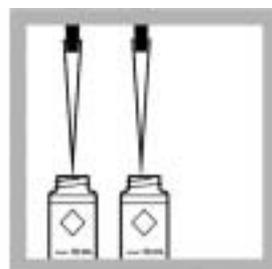
8. 使用 TenSette® 移液管往每个样品池中加入 3 mL THM Plus 2 试剂。
