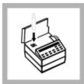
26 将样品放入样品的插槽中。将盖子盖在插槽上。
