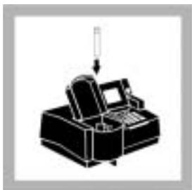
5. 将空白放入插槽中，让瓶上的 Hach 标志正对着仪器的前部。盖上挡光板。
