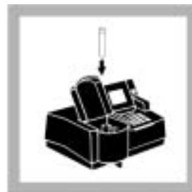
8. 将样品瓶放入插槽中，让瓶上的 Hach 标志正对着仪器的前部。盖上挡光板。屏幕上显示以 mg/L (或以所选择的单位) 表示的 COD 值。
