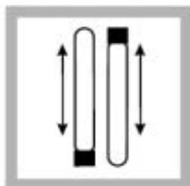
6. 握住瓶子的盖子及未被液体浸没的瓶体部分。轻轻地倒转几次以混合里面的液体。将该瓶子放在经过预加热的 COD 反应器中。
